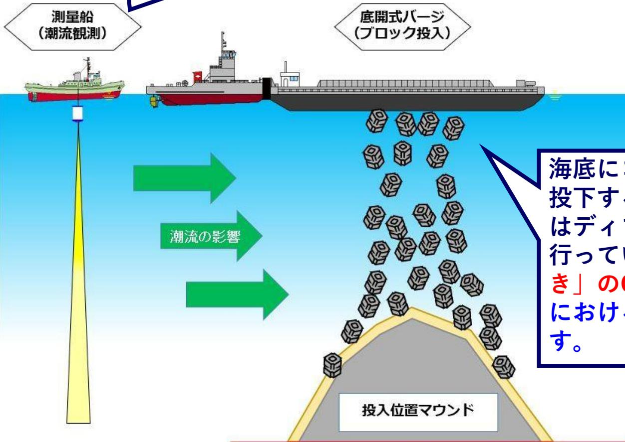
海底にコンクリートブロックを投下する際の船の測位は、従来はディファレンシャル方式で行っていたが、これを「みちびき」のCLASに置き換え、沖合における施工の高精度化を目指す。
